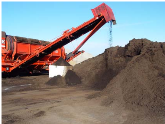
TROMMEL SCREEN AT SL LANDFILL
